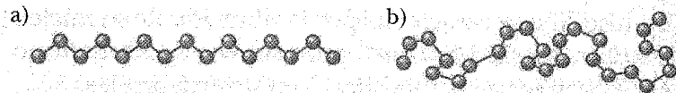
Figura 24. Esquema de una cadena hidrocarbonada: a) en configuración trans ; b) en configuración izquierda .
